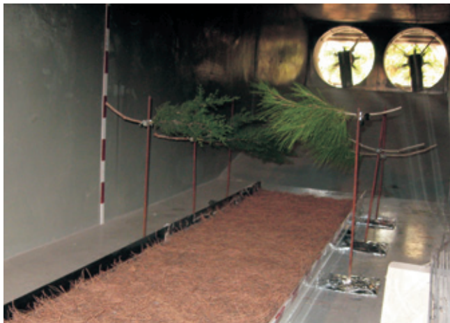
Συγκριτική πειραματική καύση κλαδίσκων κυπαρισσιού και πεύκων σε αεροσήραγγα του Μεσογειακού Αγρονομικού Ινστιτούτου Χανίων πριν το πείραμα.
